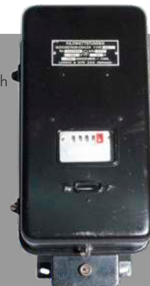
Gleichstrom-Motorzähler mit Kollektor und Bürste, 120V, 10 A Landis+Gyr AG, 1919
